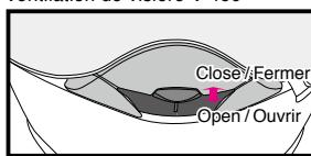
Lower Air Intake / Prise d'air inférieure
